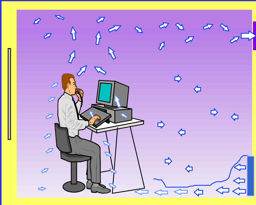
Displacement ventilation (DV)
