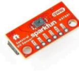
Figure 49: SparkFun Mini Spectral UV Sensor - AS7331 (Qwiic) [44]
