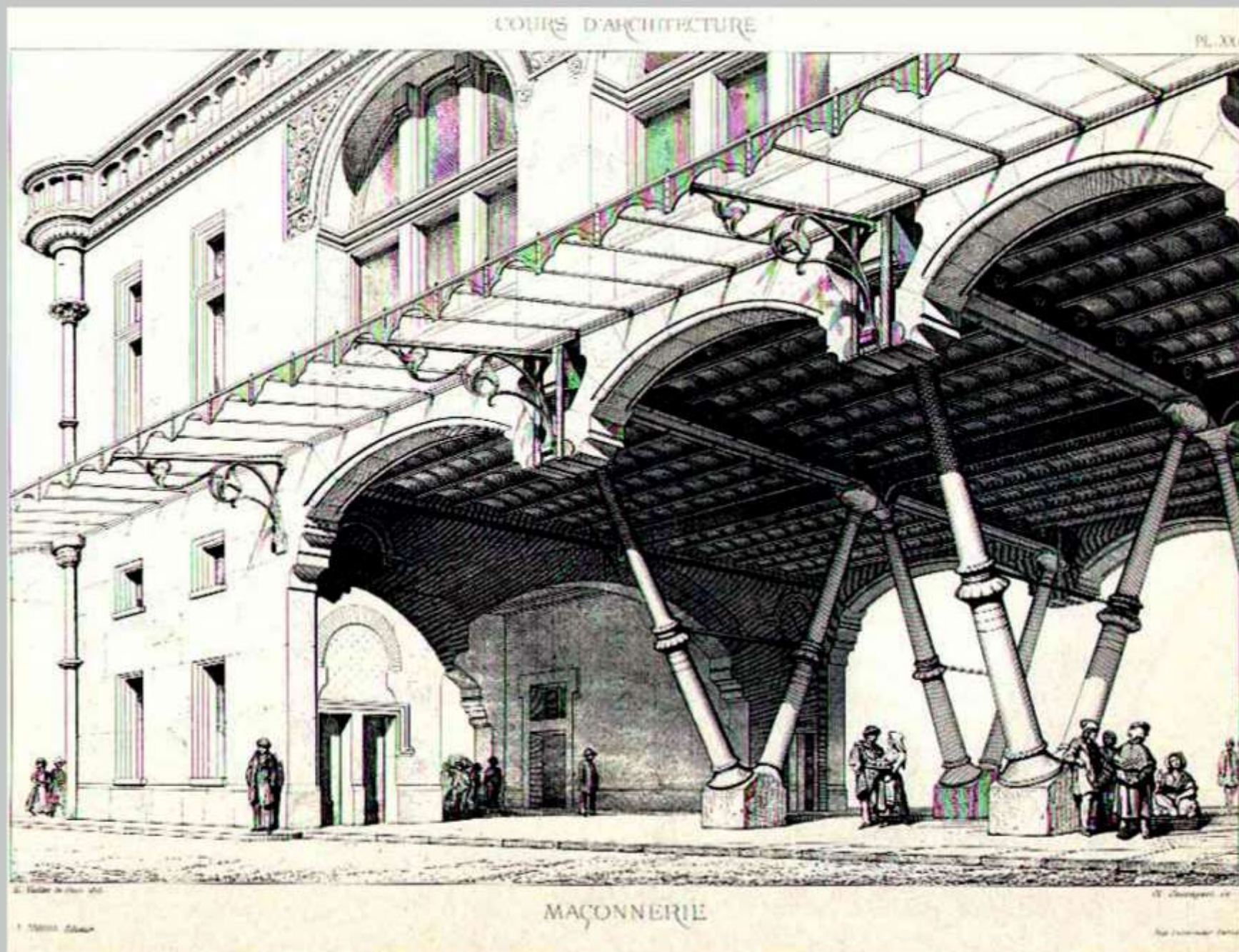
Eugène-Emmanuel Viollet-le-Duc (1814-1879), « Vue d'un marché avec salle au-dessus (fer et maçonnerie) ». Planche XXI, 12e entretien, Entretiens sur l'architecture , 1863-1872.
